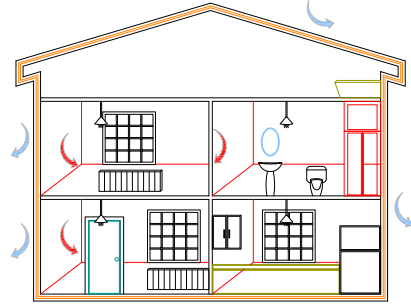
Şekil 10.2. Doğru yalıtım uygulaması ile sağlanan hava sızdırmazlığı
